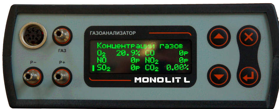
Рисунок 3 – Внешний вид газоанализаторов «MONOLIT L»
